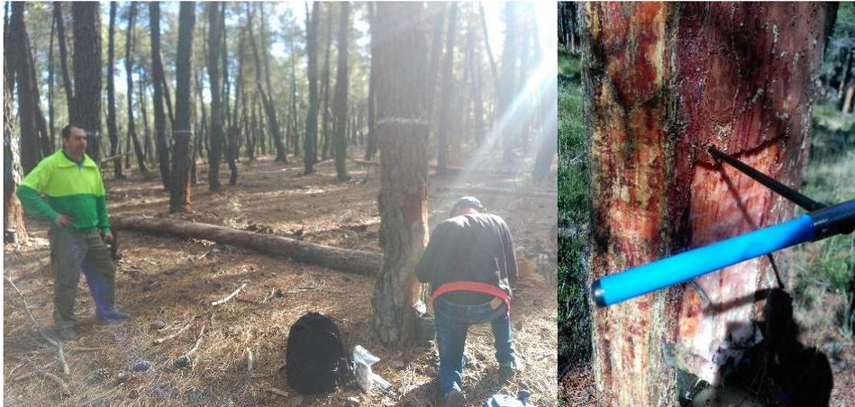
Figura 6. Extracción de la muestra con barrena de Pressler.
