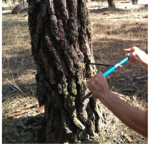
*Figura 6:* Izquierda: pesada de resina en parcela de evaluación precoz 2020. Derecha: barrenado para determinar la edad de la masa.
