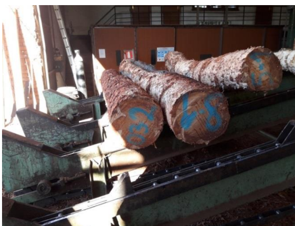
Figura 9: Foto trozas con código de identificación en cadena, durante el proceso de aserrado:
