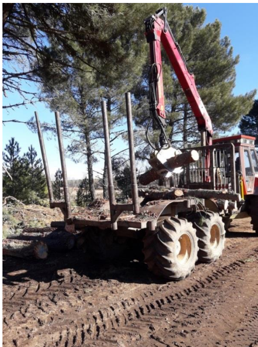
Figura 6: Foto de saca de trozas mediante autocargador
