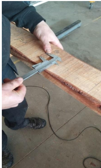
Figura 12: Foto Medición de singularidades de la madera.
