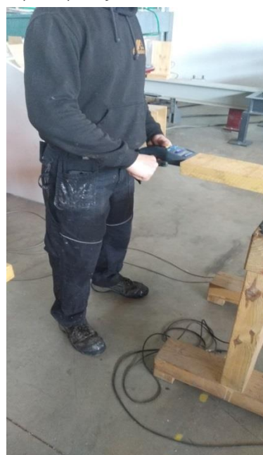
Figura 14: Foto, empleo métodos no destructivos (tiempo de paso y medición de frecuencia)
