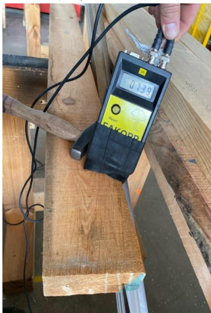
Figura 14: Foto, empleo métodos no destructivos (tiempo de paso y medición de frecuencia)
