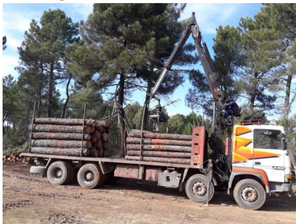
Figura 8: Foto carga de trozas en camión para su transporte a serrería.
