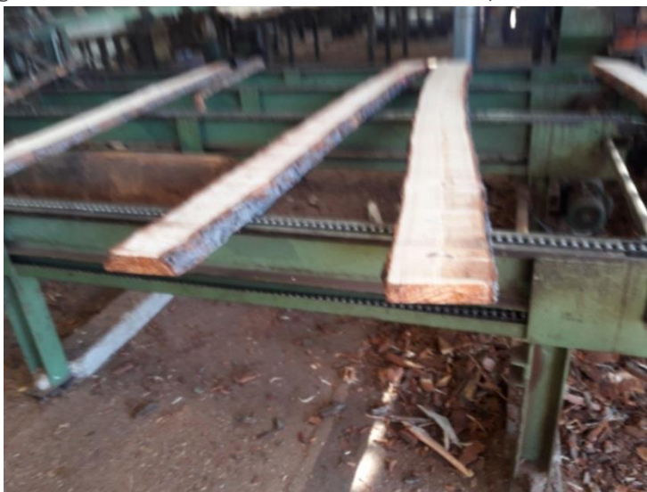
Figura 10: Foto obtención de tablones sin cantear en el proceso de aserrado
