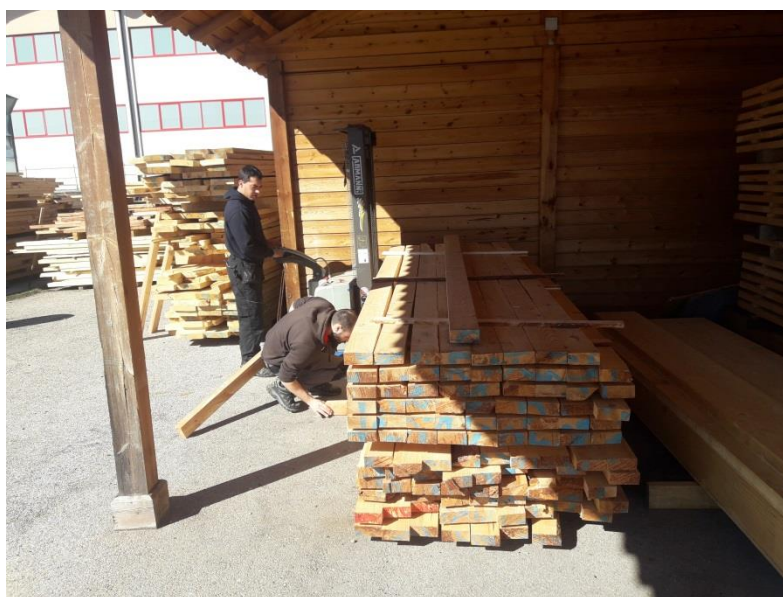
Figura 11: Foto acondicionado de la madera para su secado.
