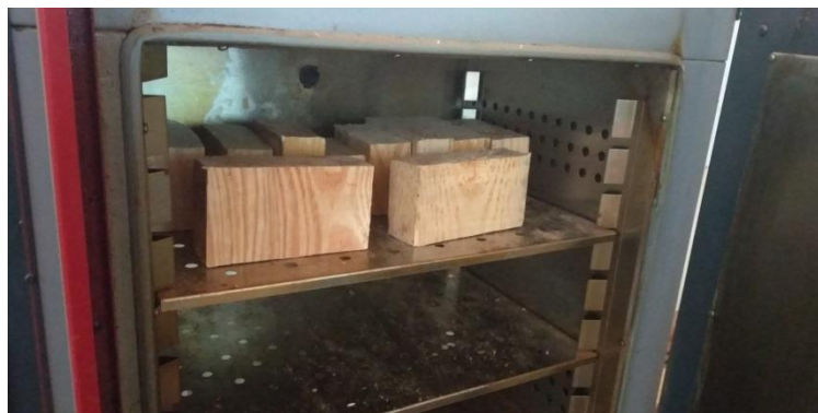
Figura 15: Foto rodajas en estufa para su secado.
