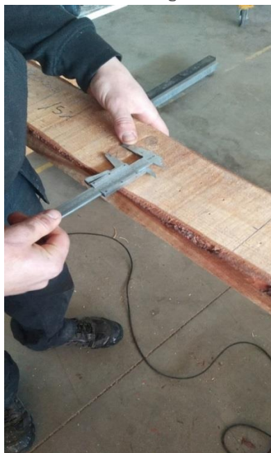
Figura 12: Foto Medición de singularidades de la madera.
