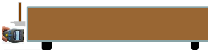
Figura 2: Sistemática en la medición de la frecuencia de vibración mediante al aparato MTG (Brookhuis).
