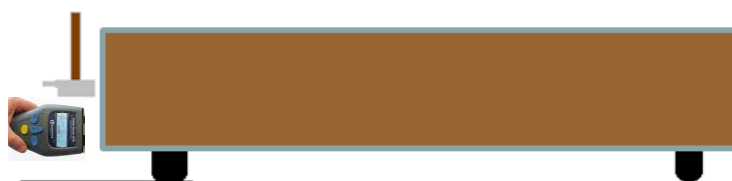
Figura 13: Sistemática en la medición de la frecuencia de vibración mediante al aparato MTG (Brookhuis).
