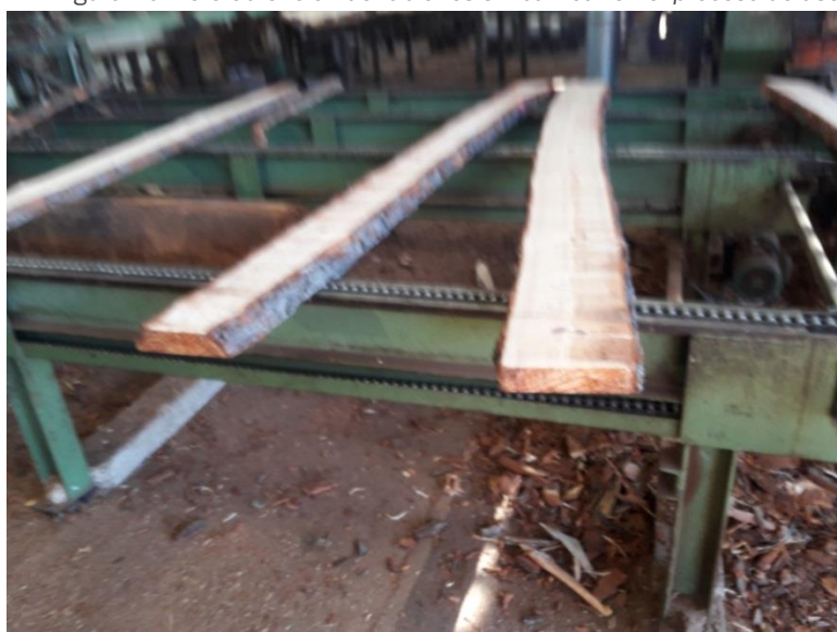
Figura 10: Foto obtención de tablones sin cantar en el proceso de aserrado
