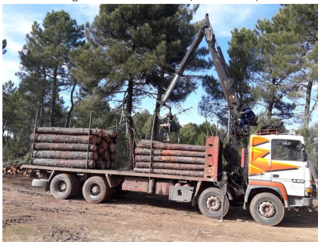
Figura 7: Foto carga de trozas en camión para su transporte a serrería.
