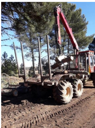
Figura 7: Foto de saca de trozas mediante autocargador
