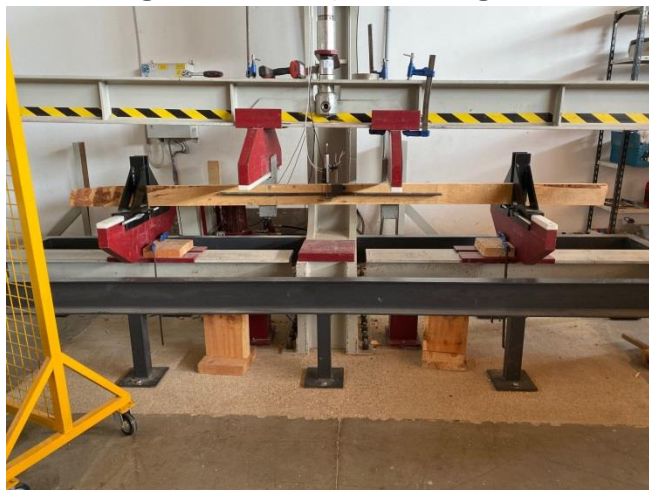
Figura 14: Foto ensayo a flexión según EN 408.
