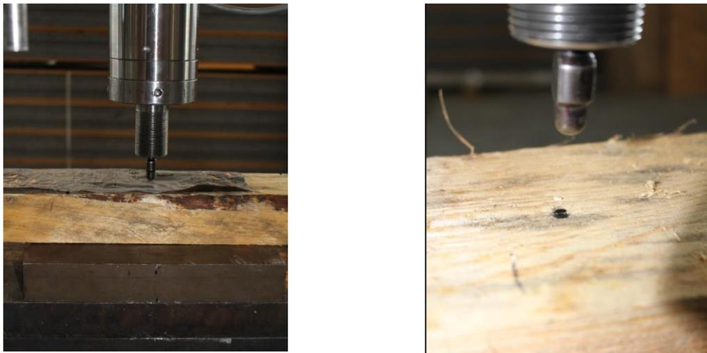
*Figure 5 : Application de la charge (à gauche) et réalisation de l'empreinte pour la mesure des deux diamètres (à droite)*
