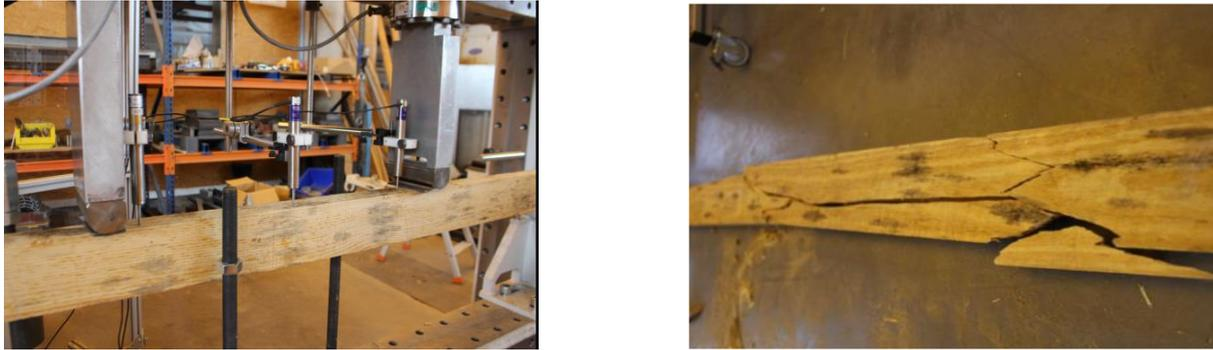
Figure 6 : Dispositif expérimental pour tester en flexion les planches bois construction : bâti d'essai de flexion quatre points (à gauche) et rupture planche n°2285 (à droite)
