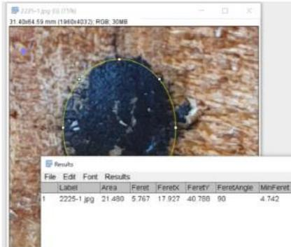
Photographie 5 : Analyse de l'empreinte sous le logiciel Fiji et calcul des diamètres
