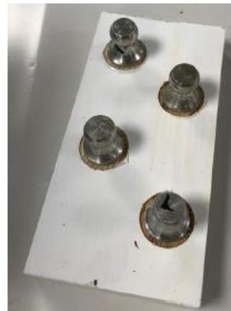
Figure 35 et 36: collage des plots pour test positest et ébavurage de la colle autour des plots pour test Positest
