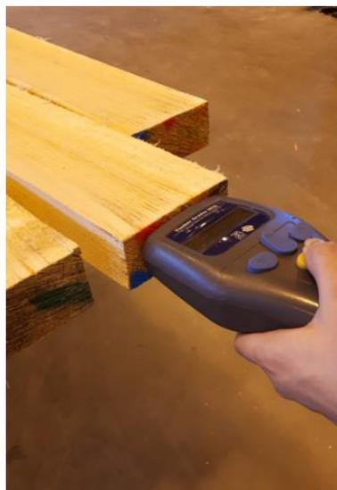
Figure 4: mesure du module élasticité dynamique par MTG
