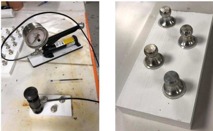
Figure 8 : vue d'ensemble du matériel Positest (à gauche) et collage des plots pour le Positest (à droite)
